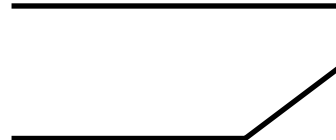
BOTTOM BEVEL EDGE CANTO BISELADO INFERIOR
